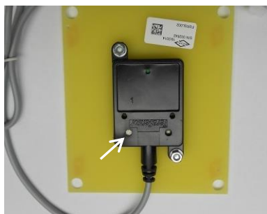
Figura 23 – Regulação da sensibilidade do sensor de nível
