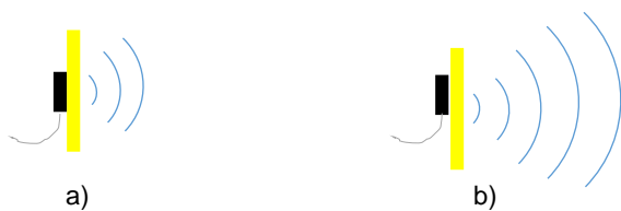
Figura 22 – Diferença entre sensor de nível com baixa sensibilidade (a) e alta sensibilidade (b)
