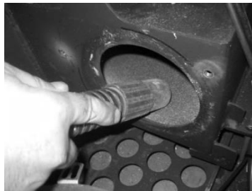
Figura 26 – Aspirar a zona de passagem do ar
