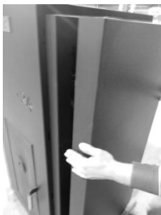
Figura 13 – remoção das capas laterais
