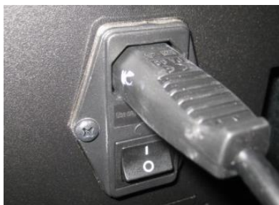
Figura 7 – Ficha ligação corrente eléctrica.
