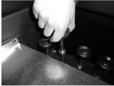
Figura 27 - Limpeza dos turbuladores
