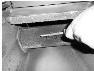
Figura 28 - Limpeza do interior da caldeira a água
