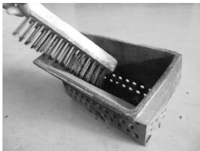
Figura 30 - Limpeza do cesto de queima
