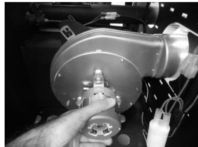
Figura 33 - a) Retirar os parafusos; b) Retirar extractor
