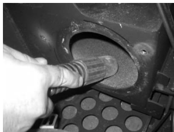
Figura 34 - Aspirar a zona de passagem do ar
