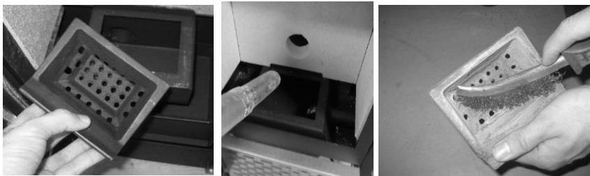
Figura 21 – Limpeza do interior da camara de combustão e o queimador
