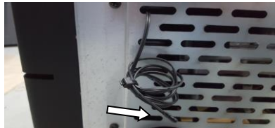
Figura 9 – sonda de temperatura ambiente
