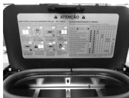
Figura 19 – Etiqueta com as tarefas de manutenção
