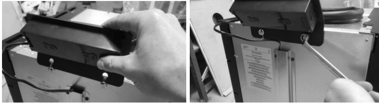
Figura 17 – Fixação do display
