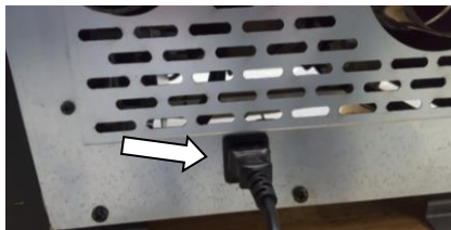
Figura 8 – Ficha ligação corrente elétrica
