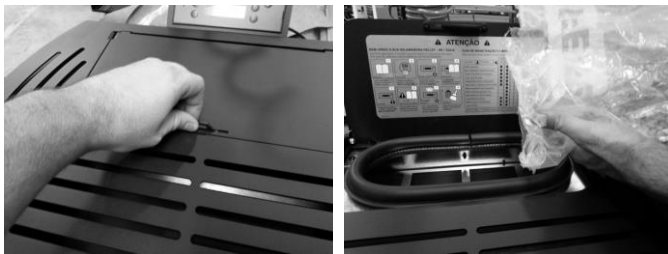
Figura 18 – Abastecimento do deposito de pellets
