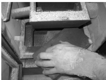
Figura 31 - Limpeza do interior da compacta
