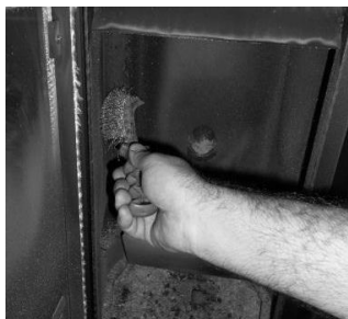
Figura 28 - Limpeza do interior da compacta a água
