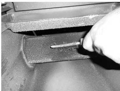
Figura 28 - Limpeza do interior da compacta a água
