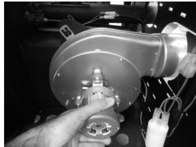
Figura 33 - a) Retirar os parafusos; b) Retirar extractor
