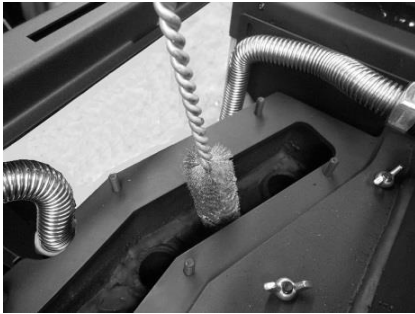
Figura 32 - Limpeza dos canais de passagem de ar e turbuladores
