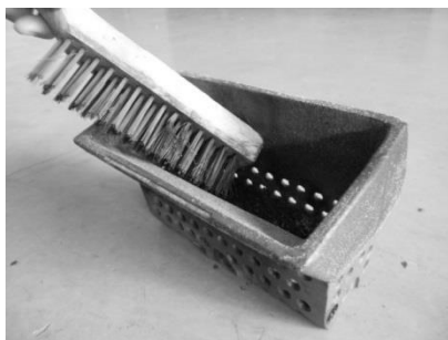
Figura 30 - Limpeza do cesto de queima
