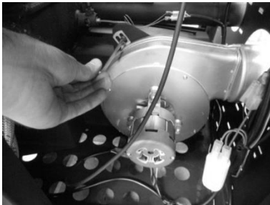
Figura 33 - a) Retirar os parafusos; b) Retirar extractor
