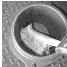
Figura 51 – Limpeza do queimador e do prato de limpeza
