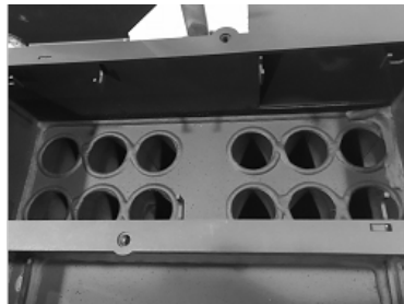
Figura 50 – Limpeza dos canais de passagem de ar e turbuladores
