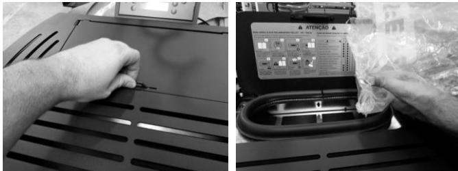
Figura 17 – Abastecimento do depósito de pellets
