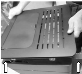
Figura 14 – Remoção tampo superior
