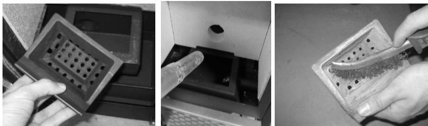
Figura 20 – Limpeza do interior da camara de combustão e o queimador
