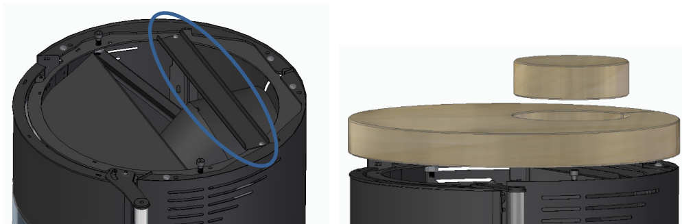
Figura 14 - Colocação do tampo em pedra no equipamento com saída de fumos na horizontal
